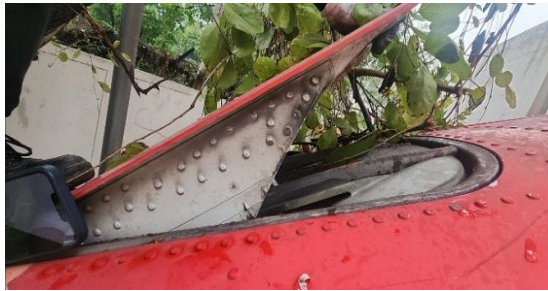
Figure 10 APU Air Inlet Door
